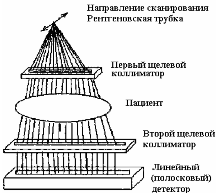
Рис. 1. Система линейного сканирования для цифровой рентгенографии грудной клетки
